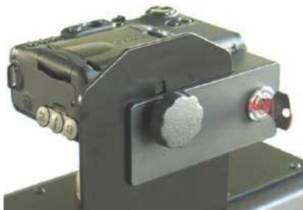
Slika št. 3: Pritrditev kamere na temno komoro
