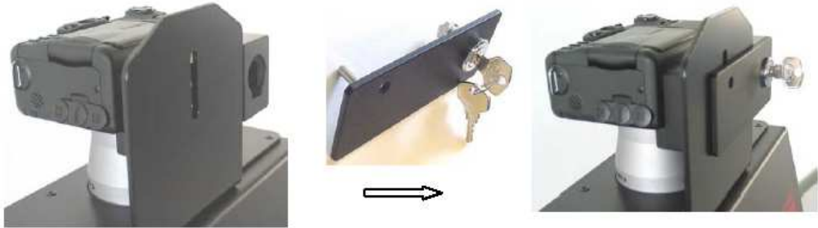
Slika št. 2: Postavitev kamere na temno komoro
