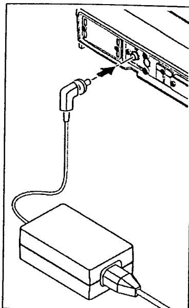
Zraven tehtnice je dobavljen adapter (primeren za 100 – 240 VAC, -101+15%, 50/60 Hz) in napajalni kabel. Če imate na lokaciji, kjer želite postaviti tehtnico, nestandardno električno napeljavo, se posvetujte s serviserjem!
