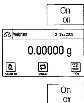
Za vklop tehnice na kratko pritisnite tipko On/Off.
