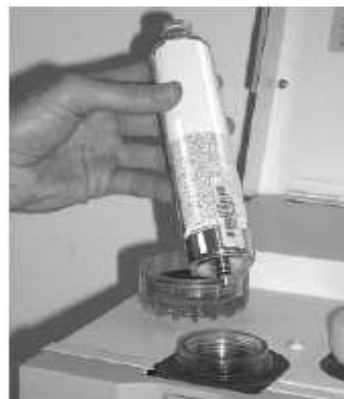
Slika 3: Vstavite novo sušilna kolono v ohišje, s konico naprej.
