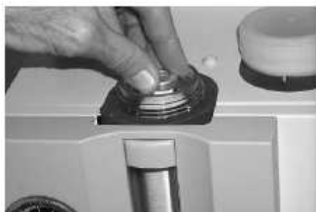
Slika 4: Močno pritisnite vrh suši/ne kolone navzdol, da o-ring na dnu ohišja zatesni.
