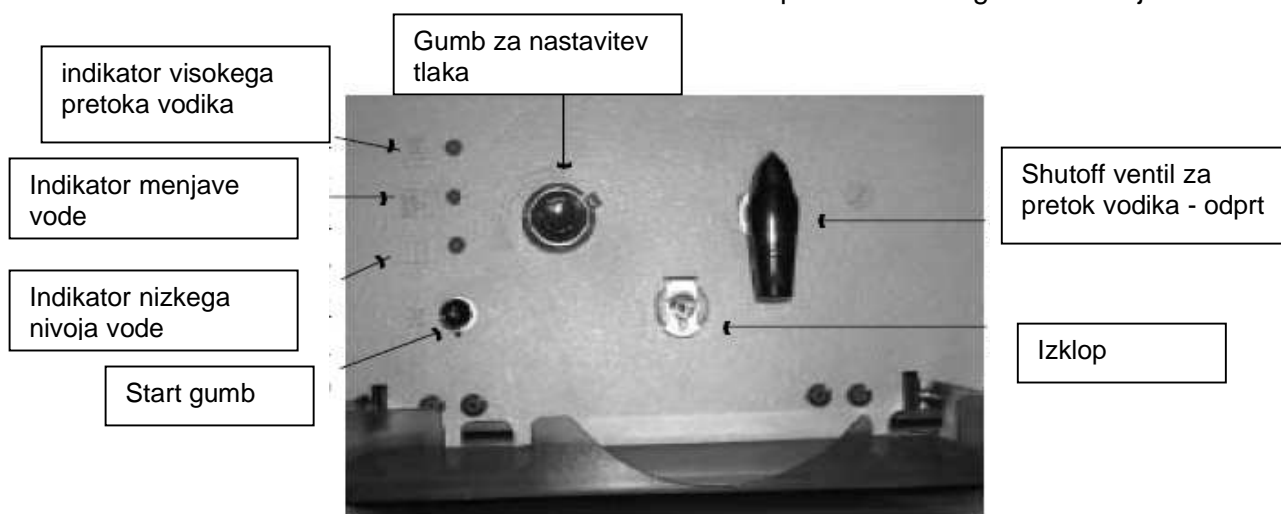
Slika 8: Indikatorji za kontrolo in napako, locirane za sprednjimi sivimi vratci
