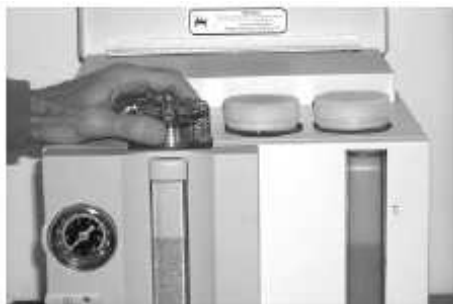
Slika 2: Odvijte pokrov ohišja sušilne kolone
